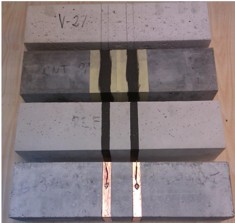
Obr. 3-14 - Fáze připevňování měděných elektrod na povrch trámců
