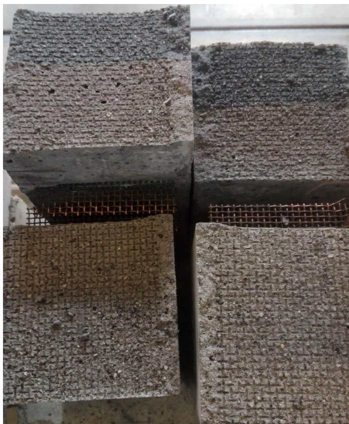
Obr. 3-11 - Porušení trámčů v místě elektrody
