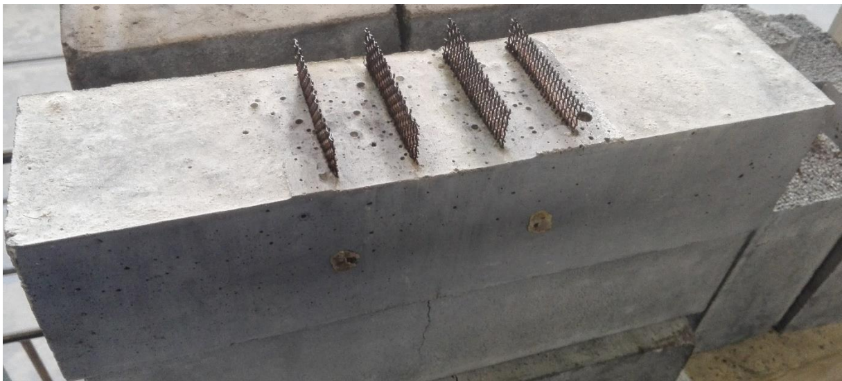
Obr. 3-10 - Měděné elektrody uvnitř trámce
