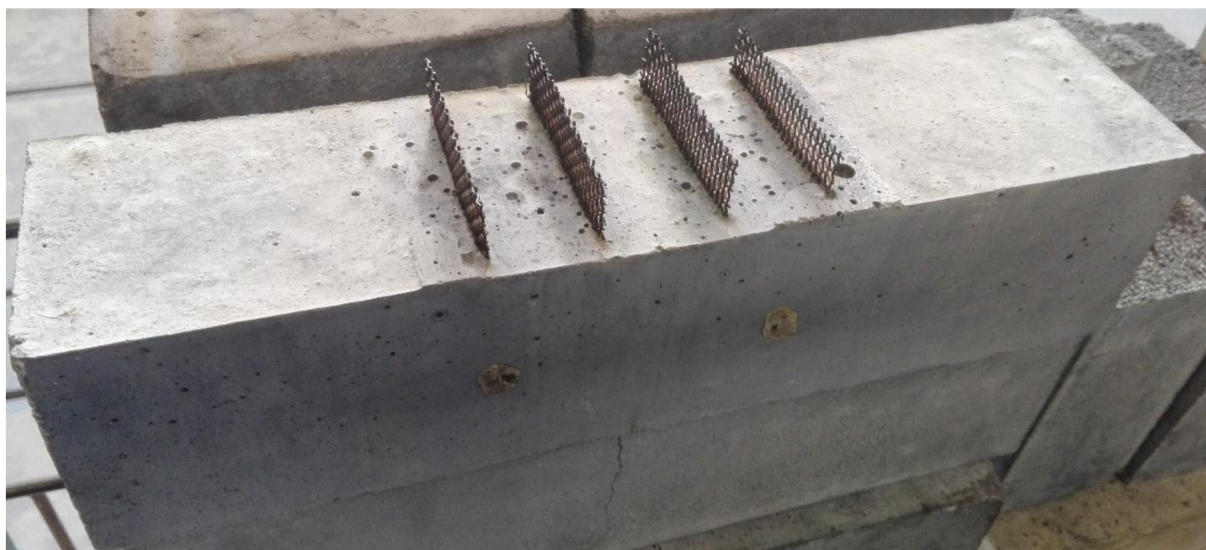
Obr. 3-10 - Měděné elektrody uvnitř trámce
