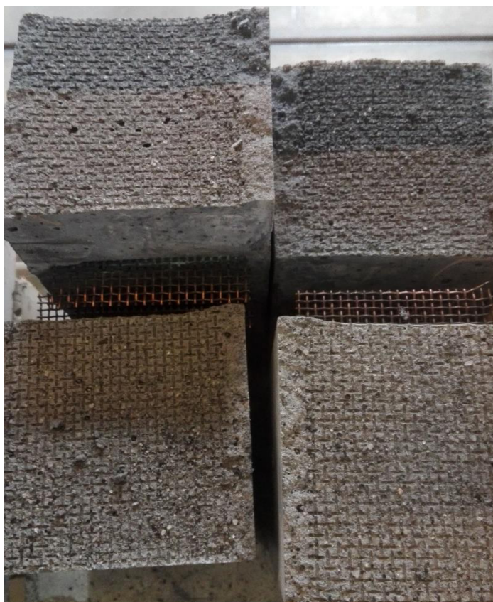
Obr. 3-11 - Porušení trámčů v místě elektrody
