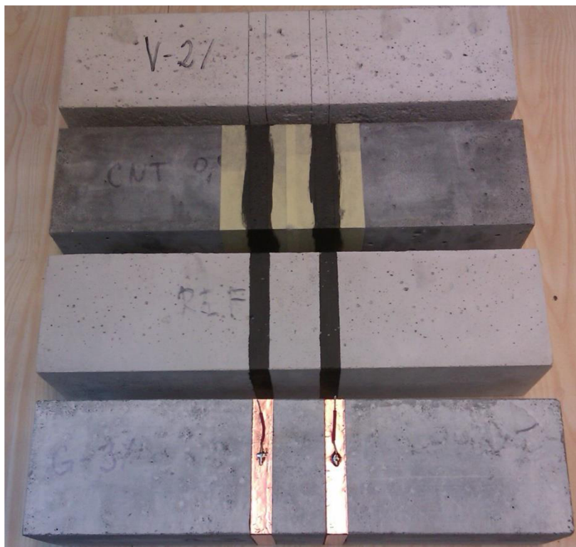
Obr. 3-14 - Fáze připevňování měděných elektrod na povrch trámců
