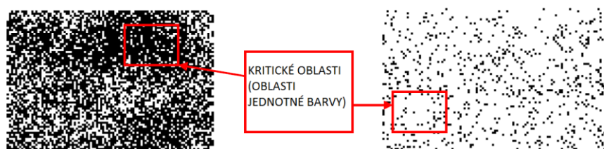
Obr. 2.30: Příklad nesprávného nanesení patternu [26]
