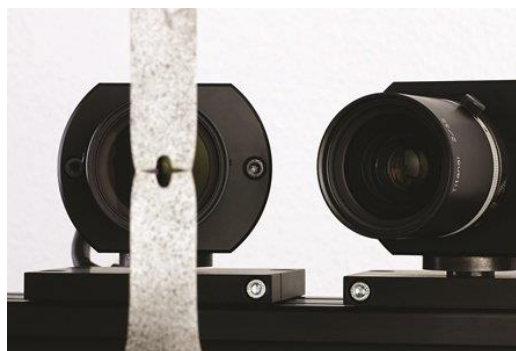
Obr. 2.26 Využití systému ARAMIS při tahové zkoušce [23]
