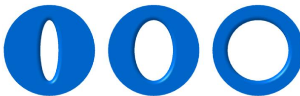
Obr. 2.28: Tvary tažnic pro zkoušku hydrostatickým vyboulováním [24]
