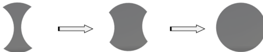
Obr. 2.29: Tvary přístřihů pro Nakazima test [24]
