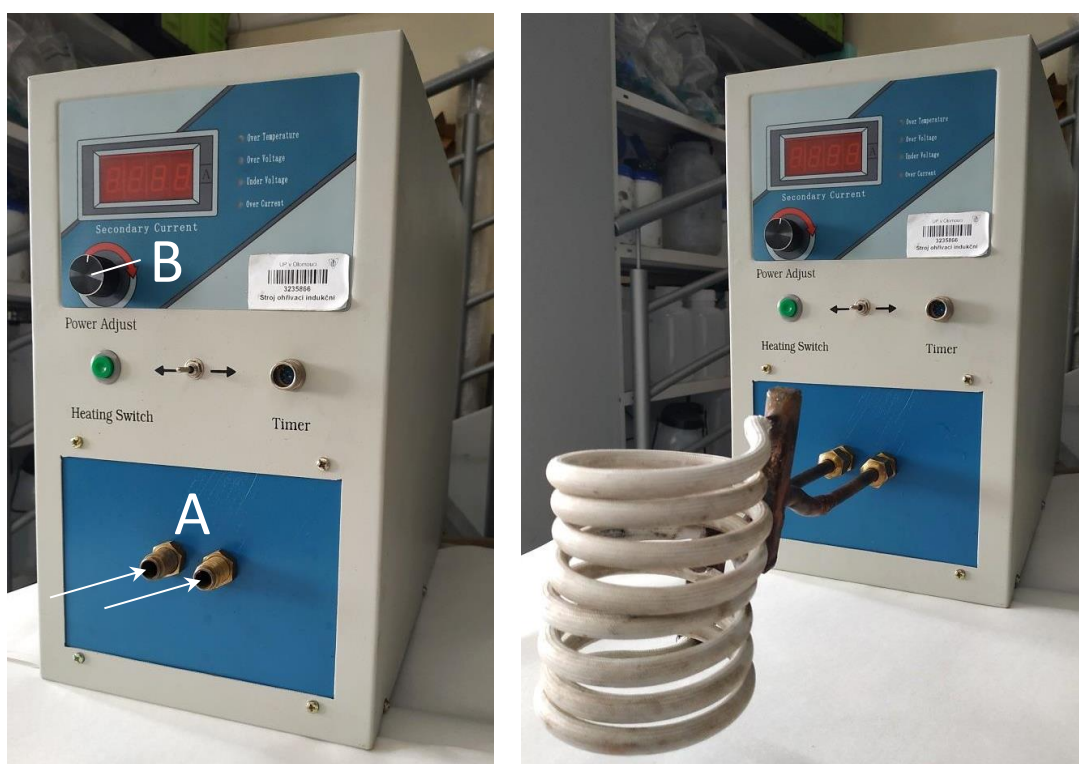
Obrázok 13: Fotografie generátora indukčného ohrevu CX-2015A (Chengdu Jinkezhí Electronic Co., Ltd., Čína) s nastaviteľnou hodnotou sekundárneho prúdu. Vľavo bez namontovanej špirálovej cievky. Časťou A je (dutá) špirálová cievka spojená s telom generátora, pričom otvormi vyznačenými bielymi šípkami prúdi do cievky chladiaca kvapalina (chladí samotnú cievku a niektoré časti generátora). Otočným prepínačom B je možné meniť hodnotu sekundárneho prúdu prechádzajúceho špirálovou cievkou. Uvedená hodnota sekundárneho prúdu má priamy vplyv na magnetickú indukciu (respektíve na výkon magneticky indukovaného ohrevu). Vpravo sa nachádza odfotografovaný generátor s namontovanou stredne veľkou špirálovou cievkou.
