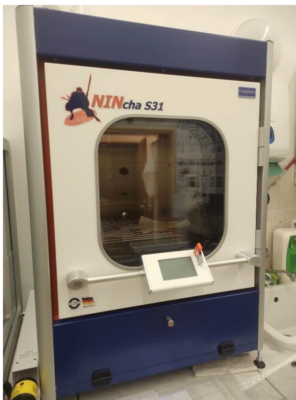
Obr. 4 – Vytvářecí komora na ninhydrin - NINcha 72
