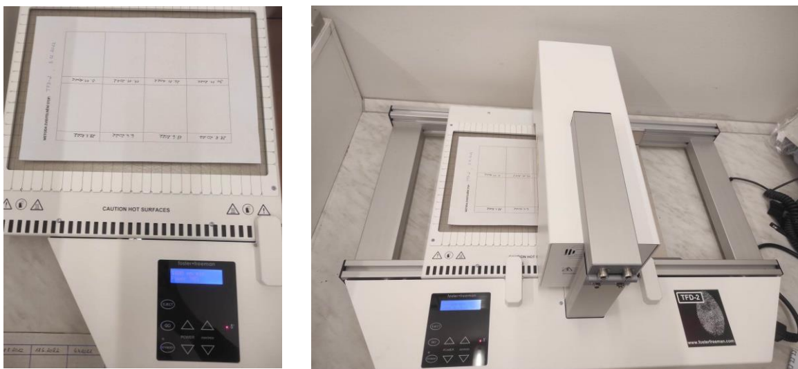
Obr. 12 – Proces zviditelňování stop pomocí termálního vyvíječe TFD-2 83
