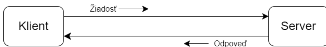
Obr. 2.2: Znázornenie komunikácie klient-server.
