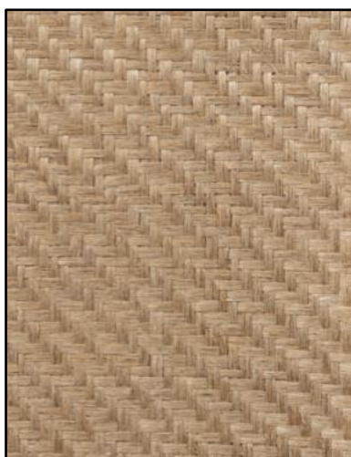
Obr. 11 – Ukázka tkaniny ampliTex™ 200 s vazbou twill 2/2 [33]
