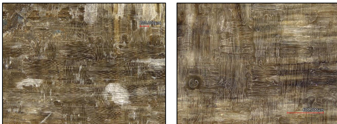
Obr. 5 – Ukázka nasákavosti spodní strany BKM, vlevo před a vpravo po
