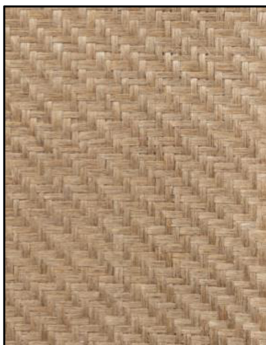
Obr. 11 – Ukázka tkaniny ampliTex™ 200 s vazbou twill 2/2 [33]
