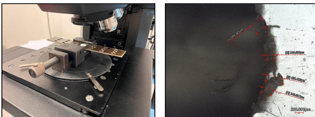
Obr. 24 – Ukázka měření delaminace
