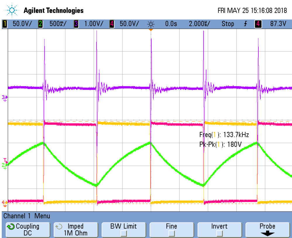
Obr. 6.18: Napětí na výstupu snímače proudu - fialový. (odpovídá návrhu – 0,335V při 5A špička špička). (zelený proud 2,5A/ dílek, žlutý a červený napětí na středech plného mostu).
