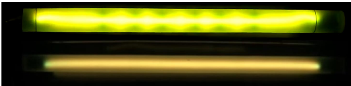
Obr. 2.5: Nahoře ukázka nestabilního výboje sodíkové výbojky při výskytu akustické rezonance. Dole hořák při správných provozních podmínkách. Převzato z [12].
