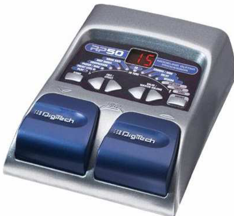
Obr. 2.3 Ukázka digitálního multieffektu RP 50 od výrobce DIGITECH, který využívá 24bitovou technologii
