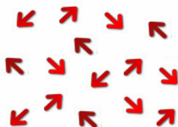
Obr. 3.3: Schéma natočení magnetických momentů paramagnetických materiálů [18].
