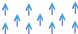
Obr. 3.1: Schéma natočení magnetických momentů feromagnetických materiálů [18].
