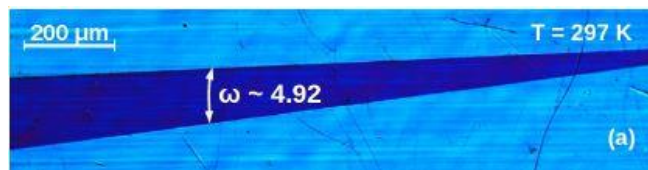
Obr 5.3: Dvojčatění Typu I a Typu II pozorované pomocí optického mikroskopu. Hranice dvojčatění nacházející se výše je Typu I, níže je Typu II [20].
