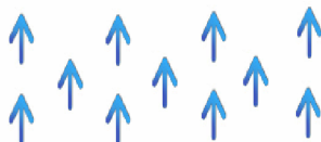
Obr. 3.1: Schéma natočení magnetických momentů feromagnetických materiálů [18].
