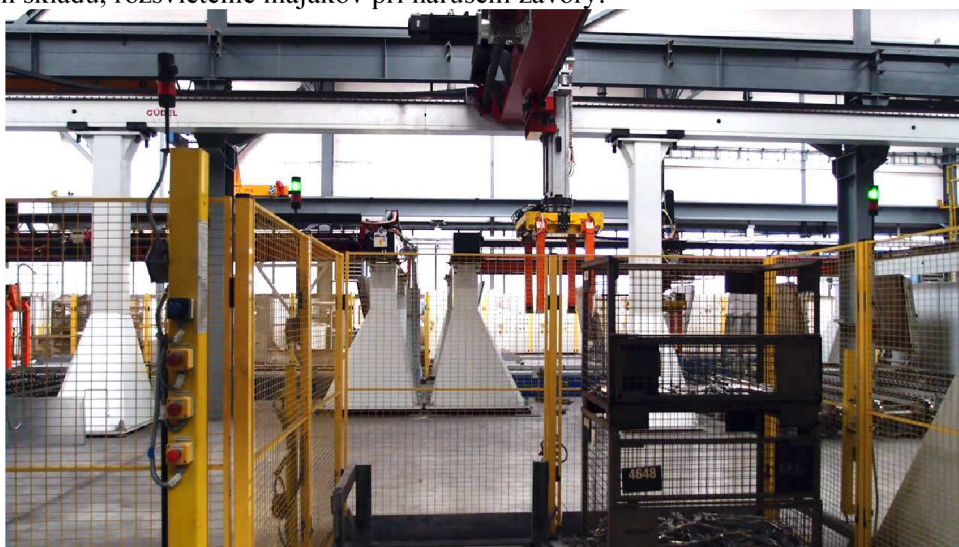
Obr. 18 Naberacie a odoberacie miesto so signalizáciou, snímačmi, húkačkou a tlačidlami
