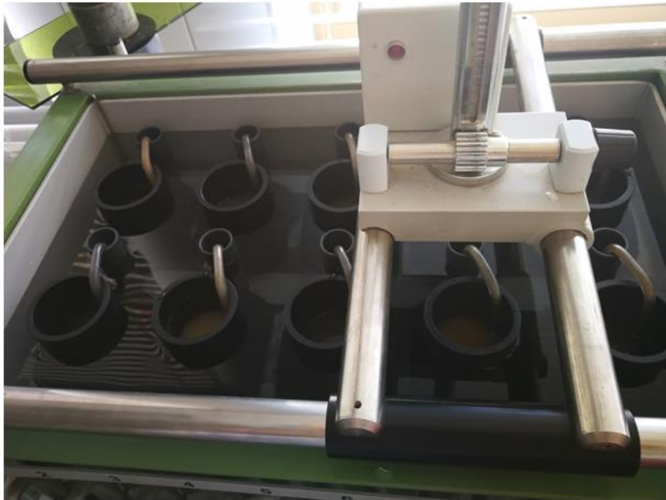
Obr. 5 Měření K_s laboratorním permeametrem
