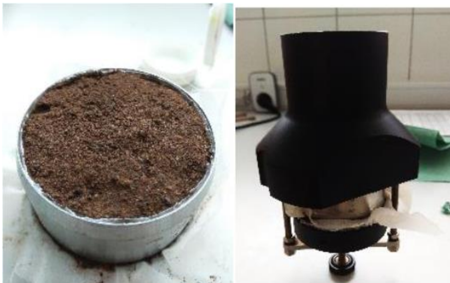
Obr. 3 a 4 Plnění mezer silikonem a vzorek upevněný v držáku (převzato z Doušová, 2019)
