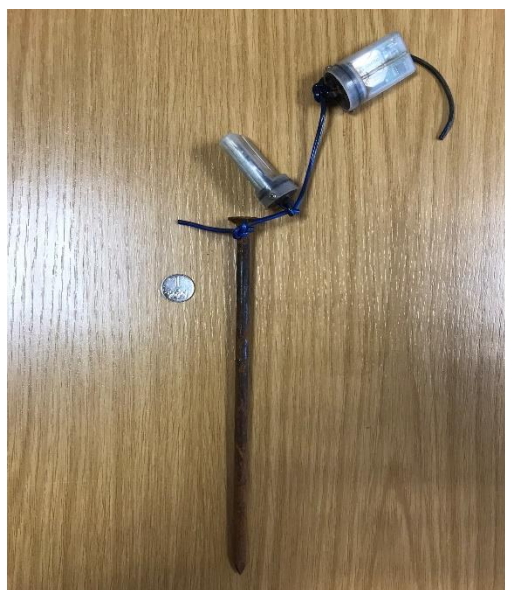
Obrázek 4.2.1 Ukázka měřicí soupravy. Dvě teplotní čidla připevněné k ocelovému hřebíku pomocí poplastovaného lanka. Souprava zdokumentována po odinstalaci z říčního dna, proto je přítomna koroze. Foto: autor práce
