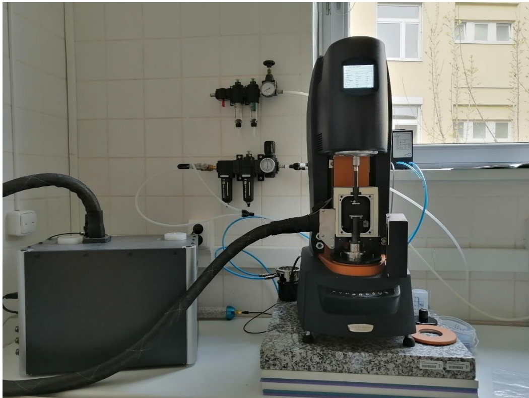
Příloha 5: Reometr Discovery HR-2 (TA Instruments) a vlhkostní cela DHR Relative Humidity Accessory (TA Instruments).
