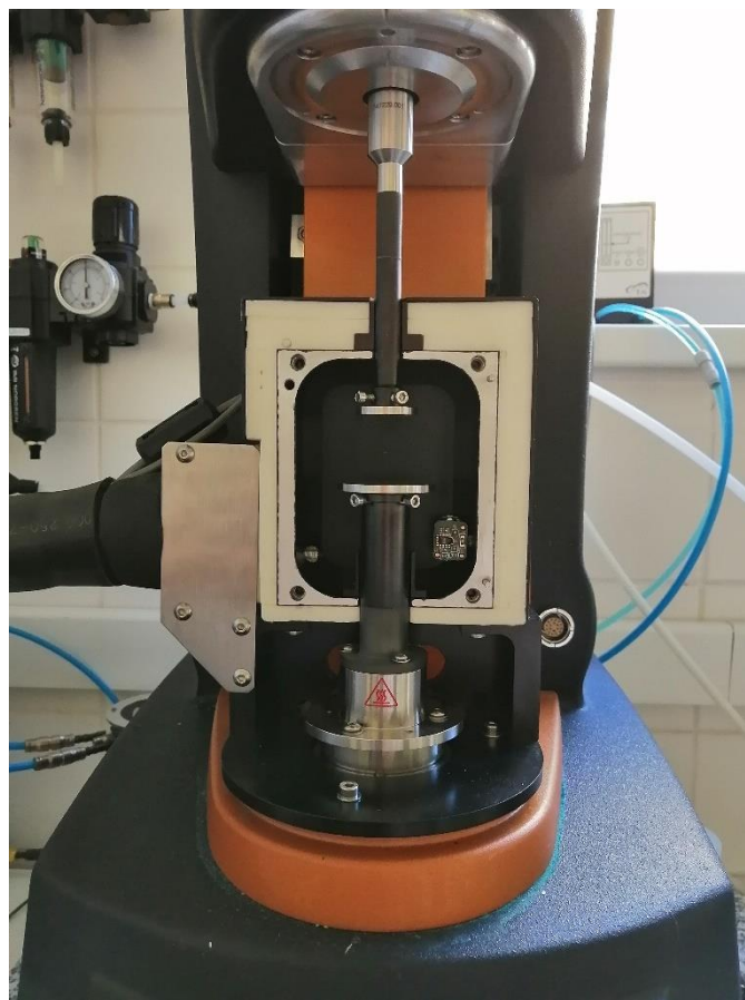
Příloha 6: Bližší pohled na měřicí komoru vlhkostní cely.
