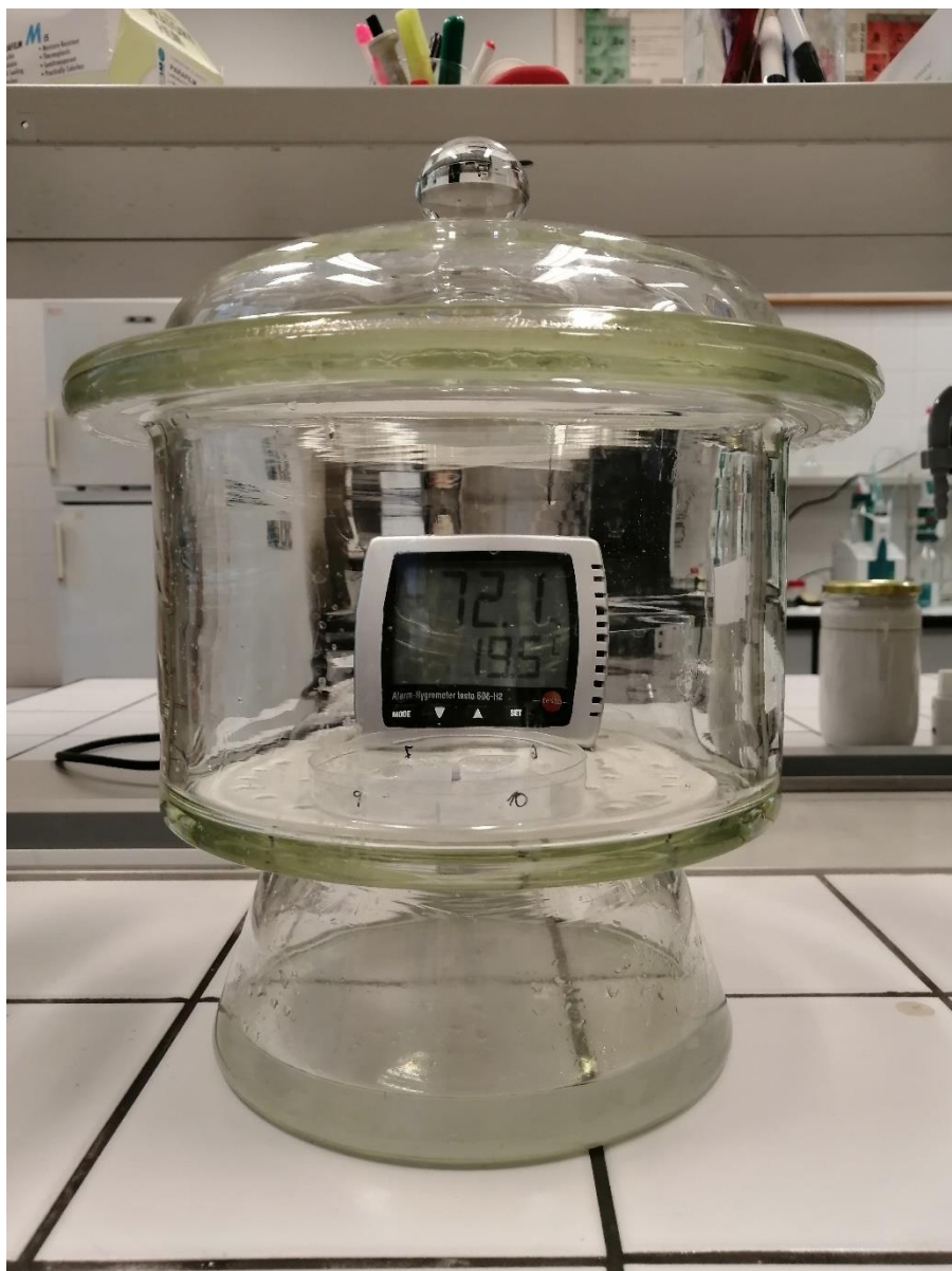
Příloha 7: Vzorky agarózových hydrogelů v exsikatoru s nasyceným roztokem chloridu hořečnatého.
