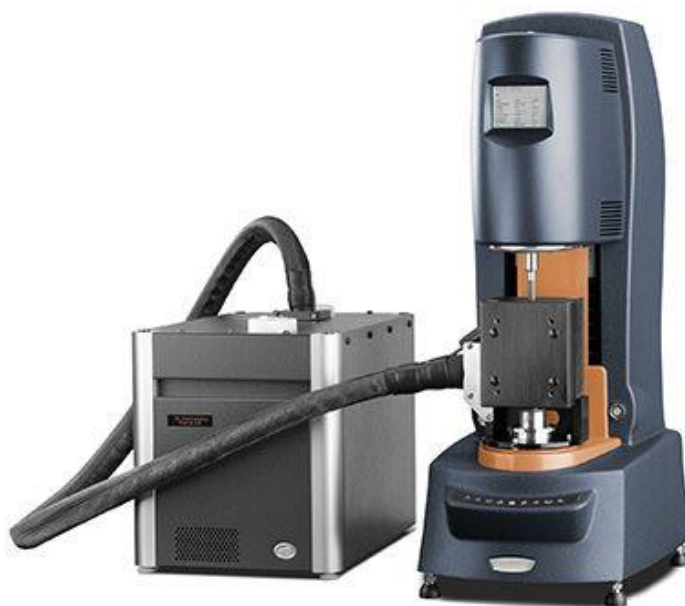
Obrázek 6: Vlhkostní cela a reometr Discovery HR-2-TA Instruments [23].
