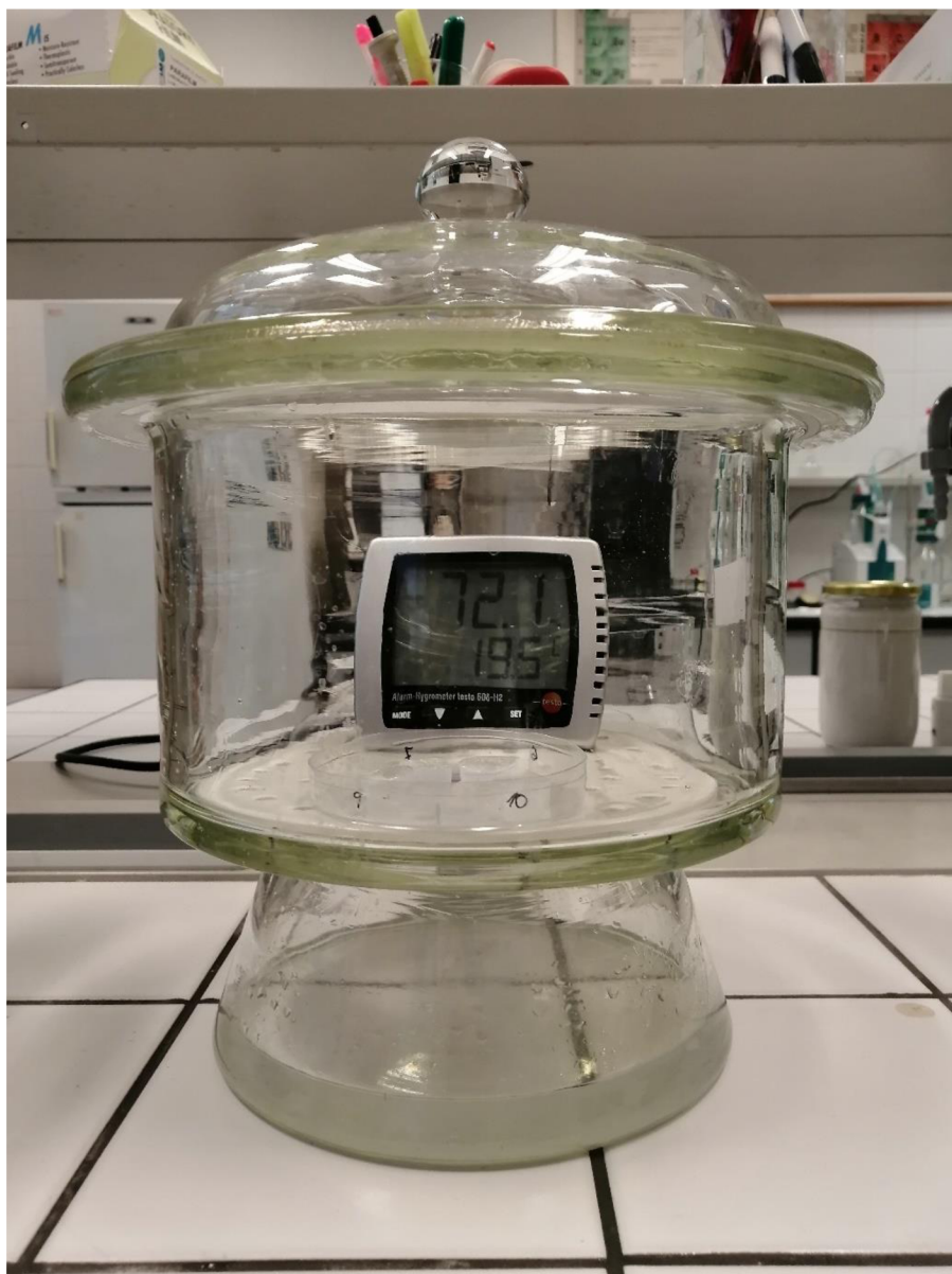
Příloha 7: Vzorčky agarózových hydrogelů v exsikatoru s nasyceným roztokem chloridu hořečnatého.
