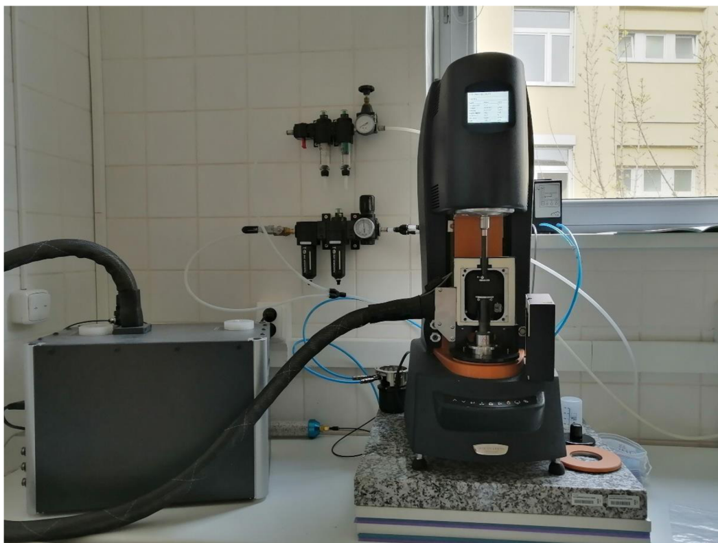
Příloha 5: Reometr Discovery HR-2 (TA Instruments) a vlhkostní cely DHR Relative Humidity Accessory (TA Instruments).
