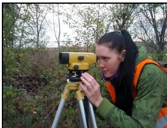
Obrázky 7: Detail zaměrování nivelační latě a hrubé horizontace (zdroj: autorka, 2014)
