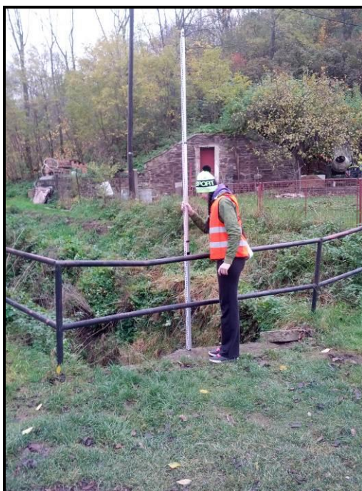
Obrázek 6: Horizontace nivelační latě (zdroj: autorka, 2014)
