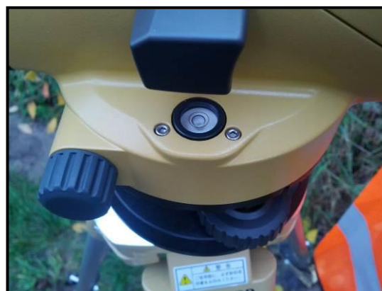
Obrázky 7: Detail zaměrování nivelační latě a hrubé horizontace (zdroj: autorka, 2014)
