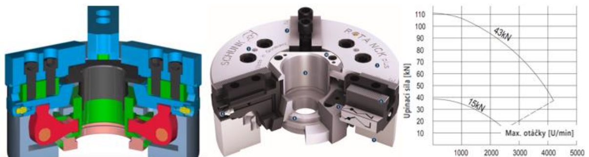
Obr. 1) Pákový mech. [1], klínový mech. [2], Průběh upínací síly v závislosti na otáčkách [3]
