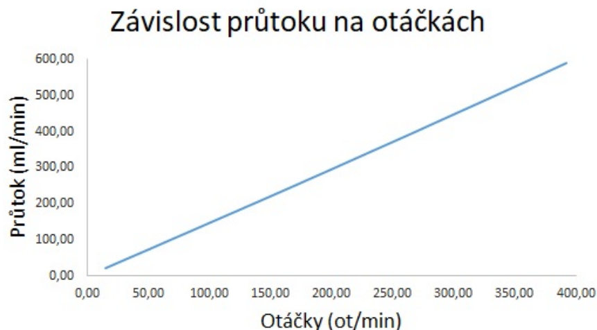
Obrázek 2.8: Graf závislosti průtoku peristaltické pumpy na otáčkách
