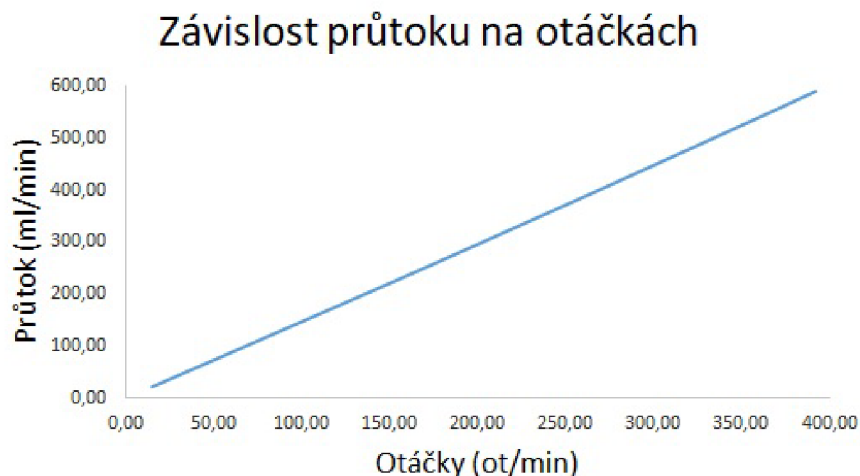
Obrázek 2.8: Graf závislosti průtoku peristaltické pumpy na otáčkách
