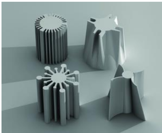
Obr. 2 Tvarově složité součásti vyrobené metodou elektroerozivního drátového řezání. [4]
