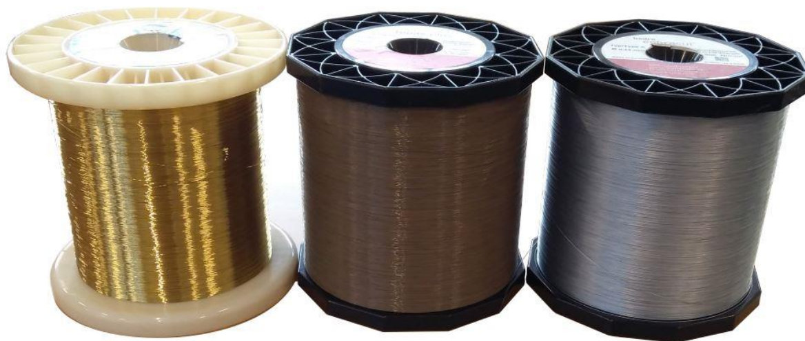
zleva: A – mosazný drát, B – povlakovaný mosazný drát, C – pozinkovaný drát
