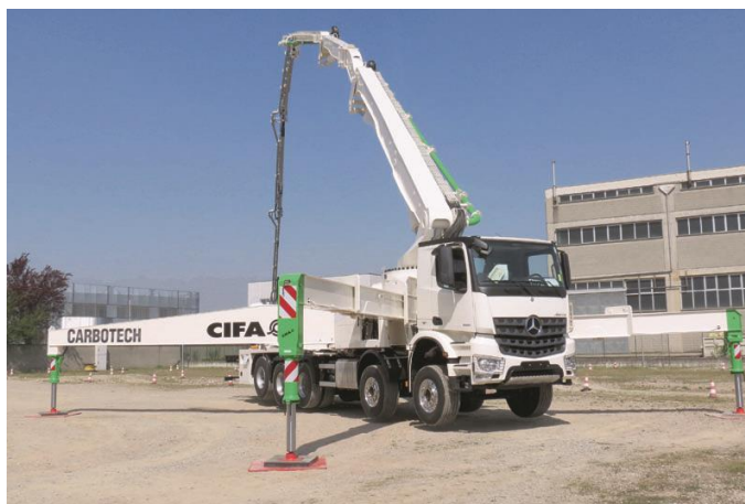
Obrázek č. 165 - Čerpadlo betonu [29]
