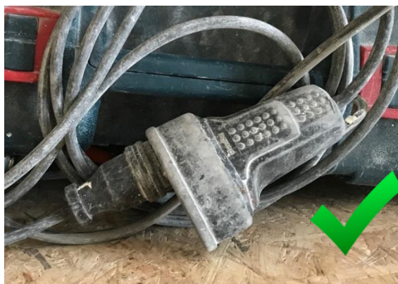
Obrázek č. 140 - Prodlužovací kabely – správně [29]
