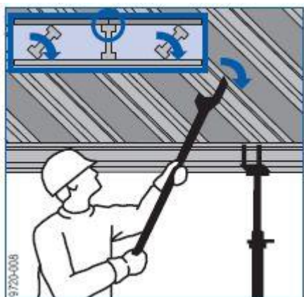
Obrázek č. 80 - Odstranění dílů [5]
