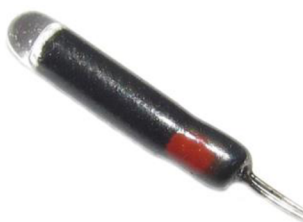
Obrázek 8: použitý fototranzistor KP101(převzato z [23])
