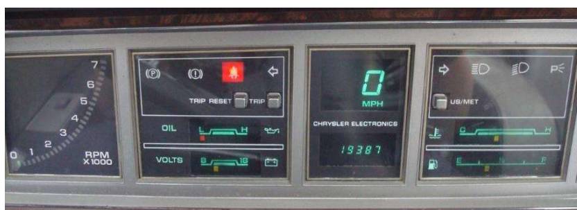
Obrázek 10: Digitální přístrojová deska [36]
