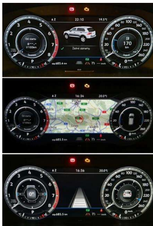
Obrázek 11: Virtuální kokpit VW Tiguan [37]
