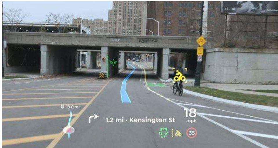
Obrázek 14: Rozšířená realita HUD [31]
