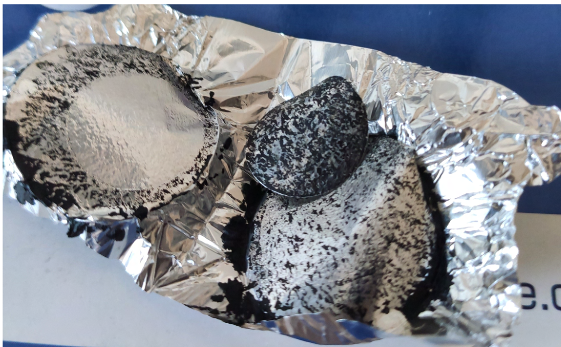
Obr. 2.31: Fotografia elektródy s výškou vrstvy 1000 \mu\text{m} po zalisovaní v hydraulickom lise.
