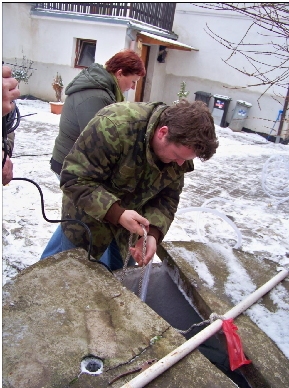
Obrázek číslo 11 – průběh čerpací zkoušky s měřením průtočného množství a výškového stavu vodní hladiny
