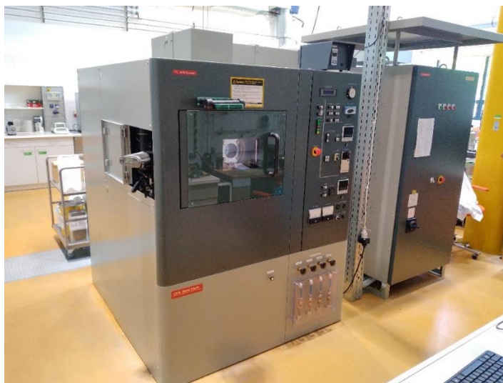
Obr. 6 Přístroj SPS sloužící ke zhutnění a slinutí keramických těles
