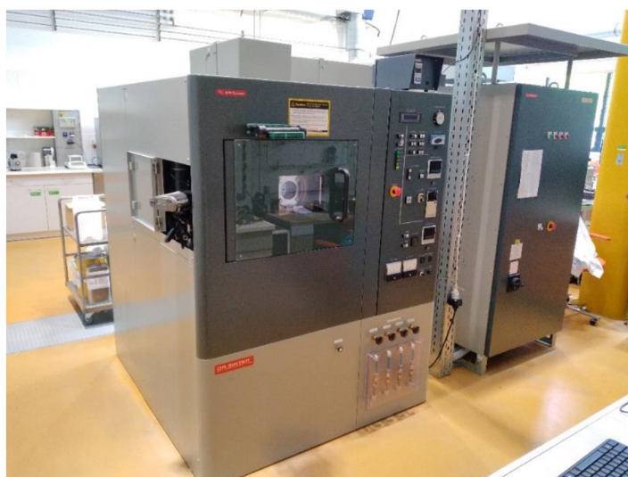
Obr. 6 Příklad přístroje SPS sloužící ke zhutnění a slinutí keramických těles
