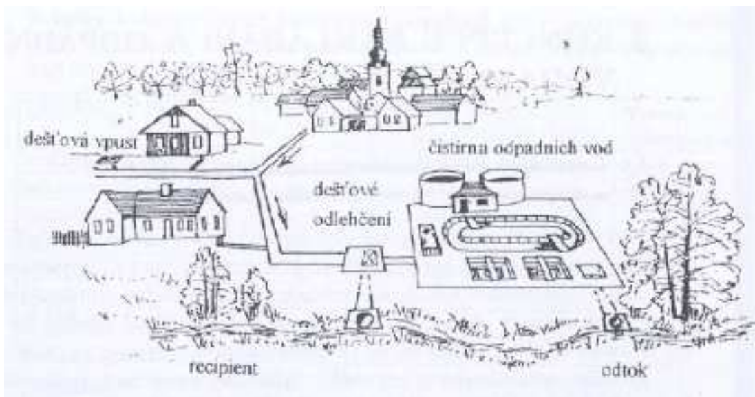
Obr.1: Centralizovaný systém odvádění a čištění odpadních vod s jednotnou kanalizací (26).
