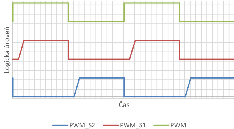
Obrázek 4.9: Ideální průběhy řídicích signálů usměrňovačů vzhledem k PWM pro řízení spínačů
