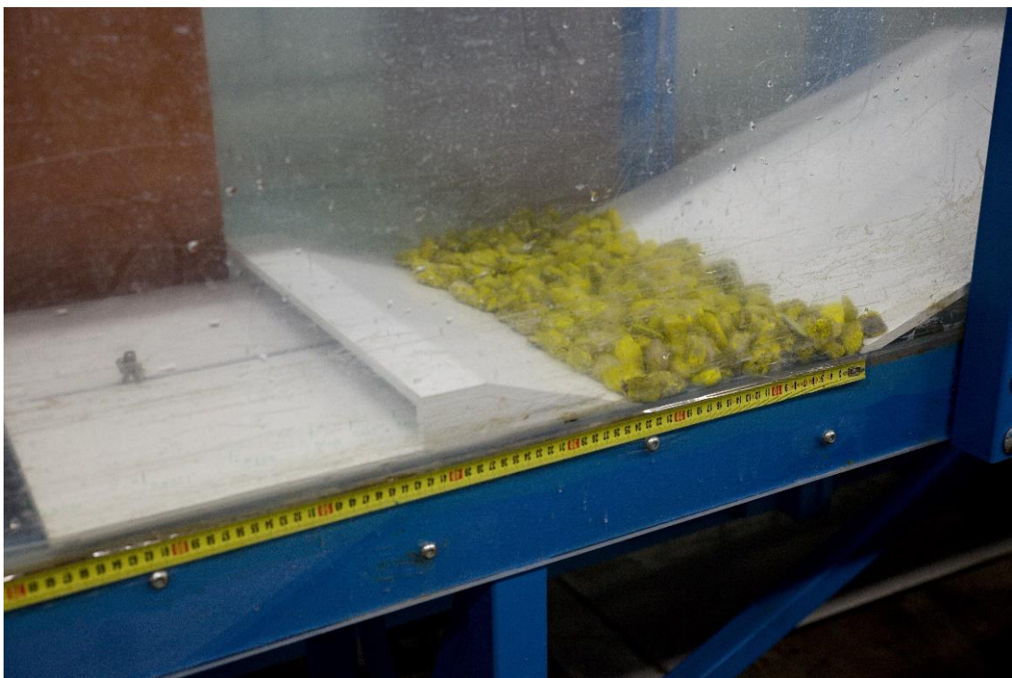
Obr. 4.15 Ukázka kameniva - usazenin ve vývaru
