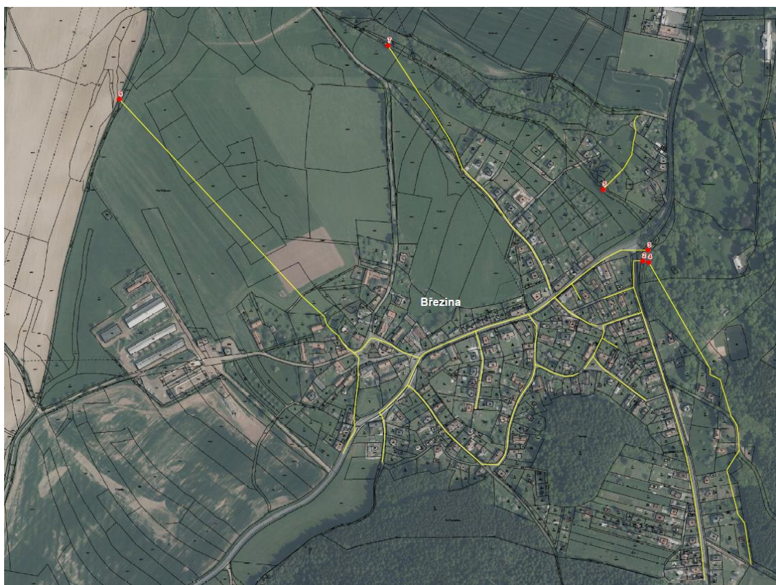
Obrázek 2 Kanalizační síť s VKV v Březině
