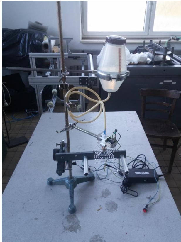
Obr. 15 Testovací zařízení savosti s tryskou
