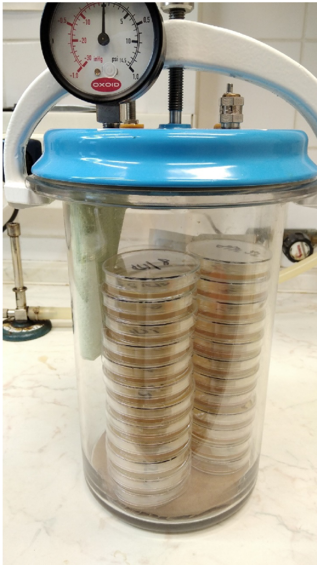
Obrázek č. 4: Vložení vzorků do anaerostatu Zdroj: vlastní
