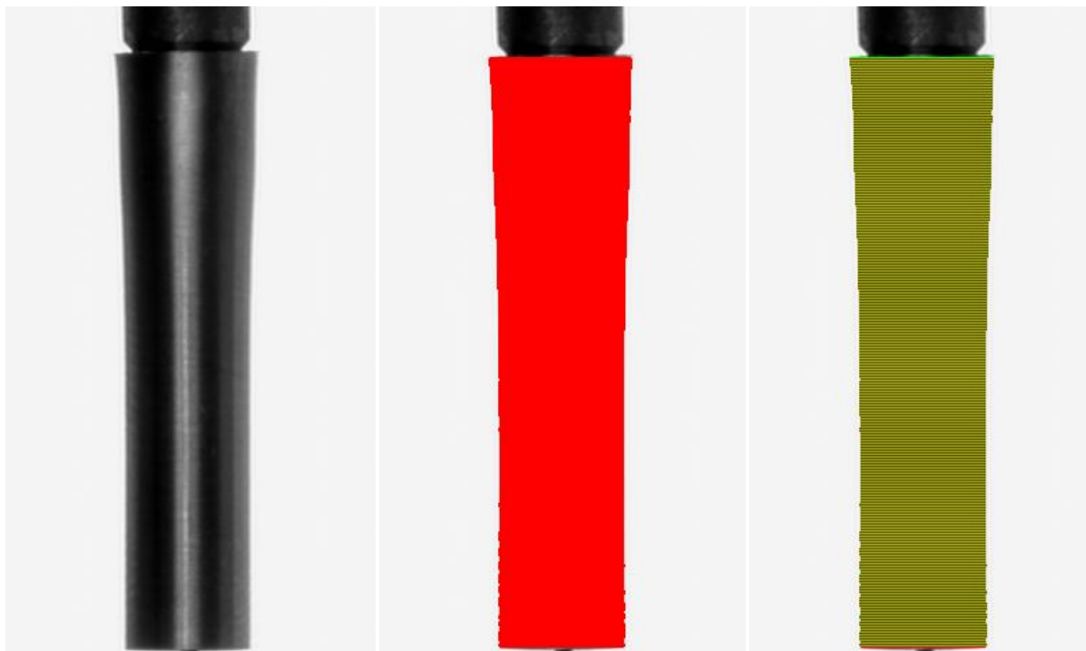
Obr. 61. Postup sejmutí kontury vzorku Ti-08 (sejmutí vzorku, zaplnění jednotnou barvou, snímání kontury)
