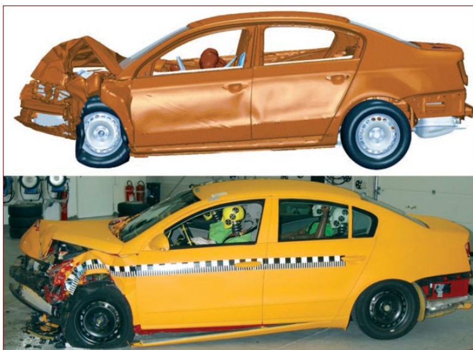
Obr. 1. Porovnání počítačová simulace nárazu automobilu do pevné překážky s reálným experimentem [41]
