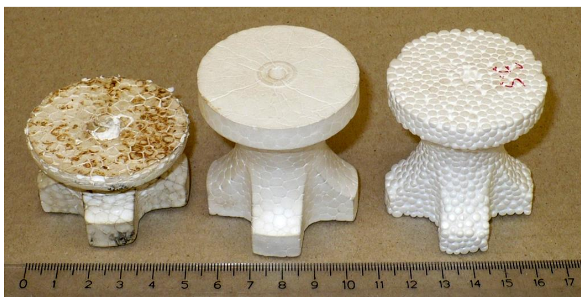
Obr. 59. Polystyrénové nosiče (nosič po nárazu, nosič z KOPLENU 1640 a 0822)
