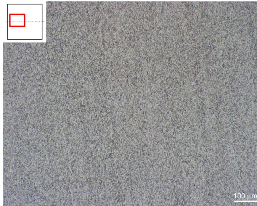
Obr. 54. Mikrostruktura vzorku Ti 11 (T = 25°C), zvětšeno 100x
