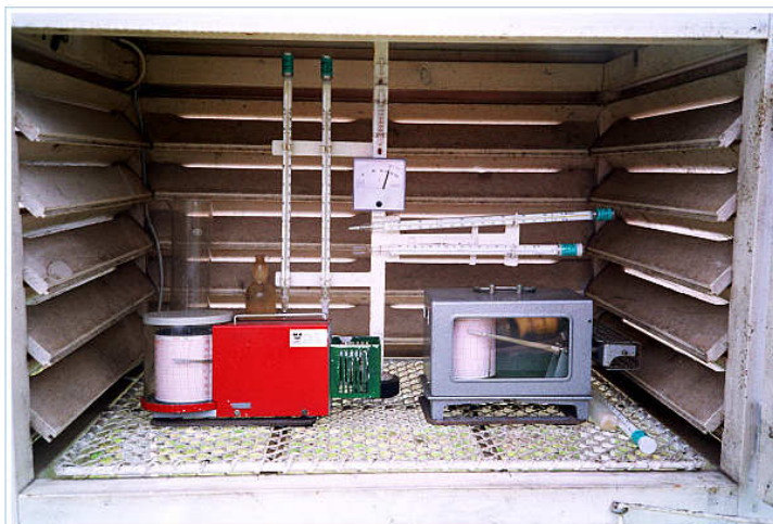
Obr. 27 Meteorologická budka s vybavením
