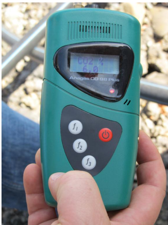
Obr. 12 Terénní přístroj Anagas 98 (© EPS, s.r.o.)
