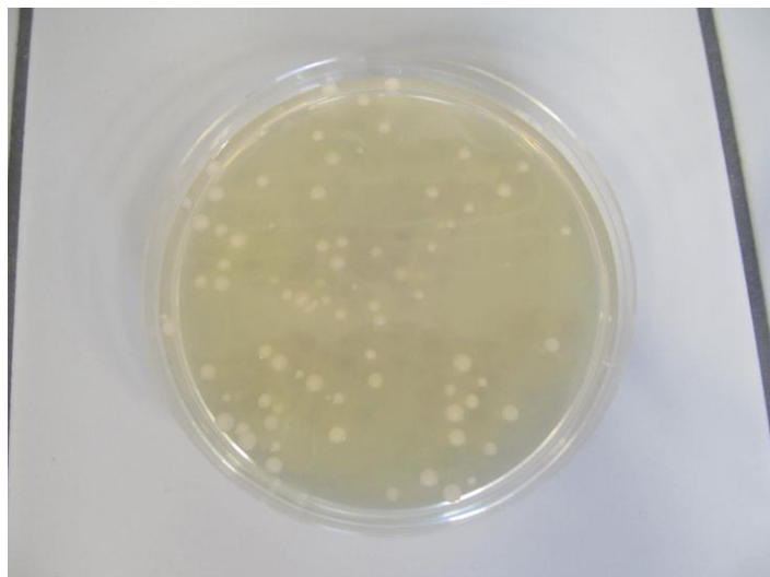
Obr. 13 Rozvoj heterotrofních mikroorganismů po 24 h inkubaci, laboratoře firmy EPS, s.r.o. (© EPS, s.r.o.)
