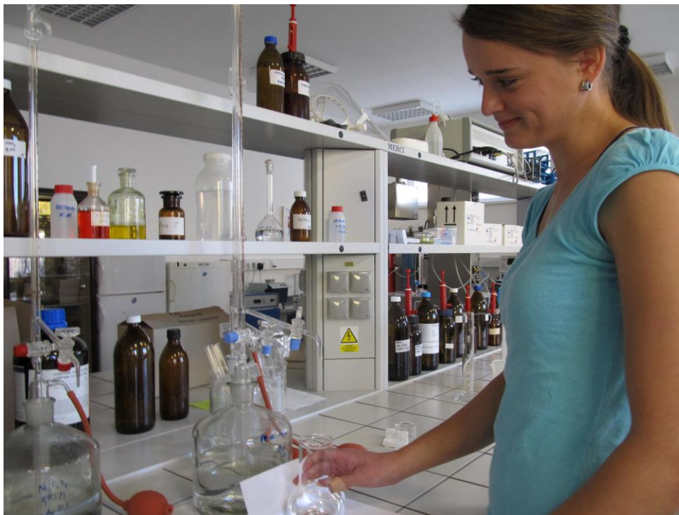
Obr. 14 Titrace pro určení množství vyprodukovaného CO 2 (© EPS, s.r.o.)
