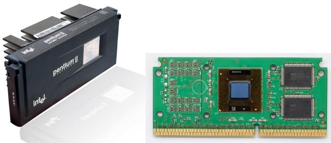
Obrázek 4 - Pentium II[93] a Pentium III (bez chladiče), řešení Slot 1[92]
