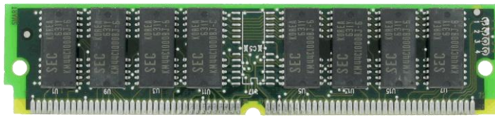
Obrázek 13 - modul SIMM 72pin, dlouhý
