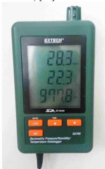
Obr. 12 Datalogger Extech v laboratoři aerosolů na FSI VUT v Brně
