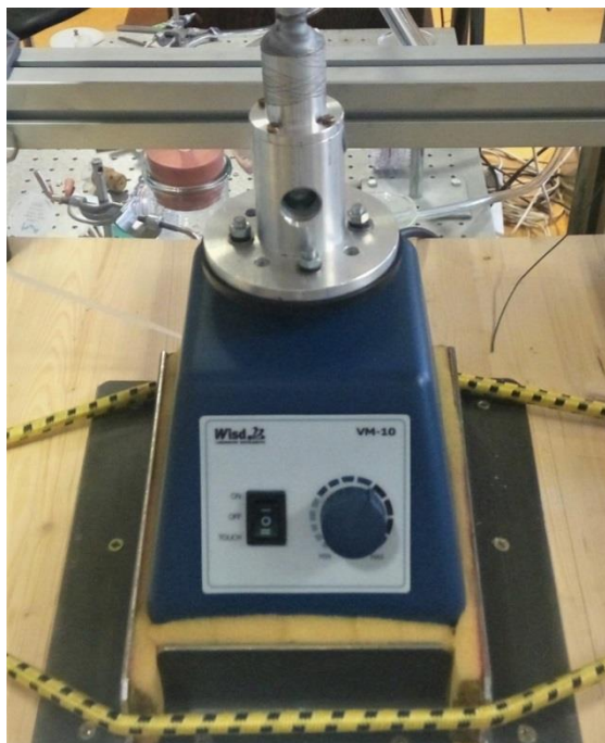
Obr. 10 Třepačka upevněná ve stojanu na molitanu tlumícím vibrace
