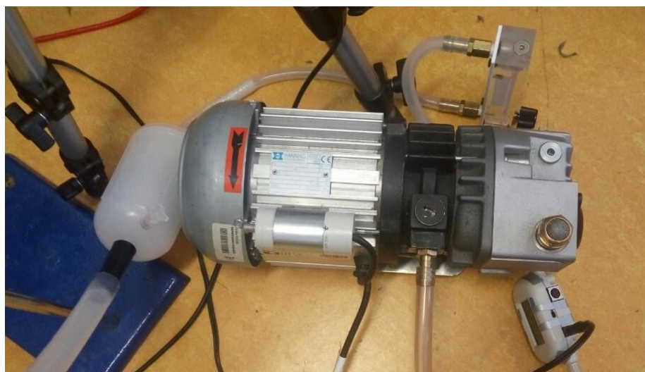
Obr. 11 Vývěva Busch a vlevo od ní Filtr millipore Opticap
