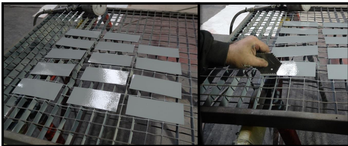
Obr. 28 - Hotový nátěr a měření tloušťky mokrého nátěru (Zdroj: Vlastní zpracování)
