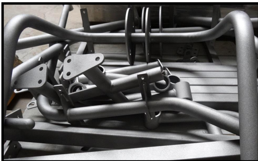
Obr. 21 – Příklad původně zkorodovaných součástí po otryskání (Zdroj: Vlastní zpracování)
