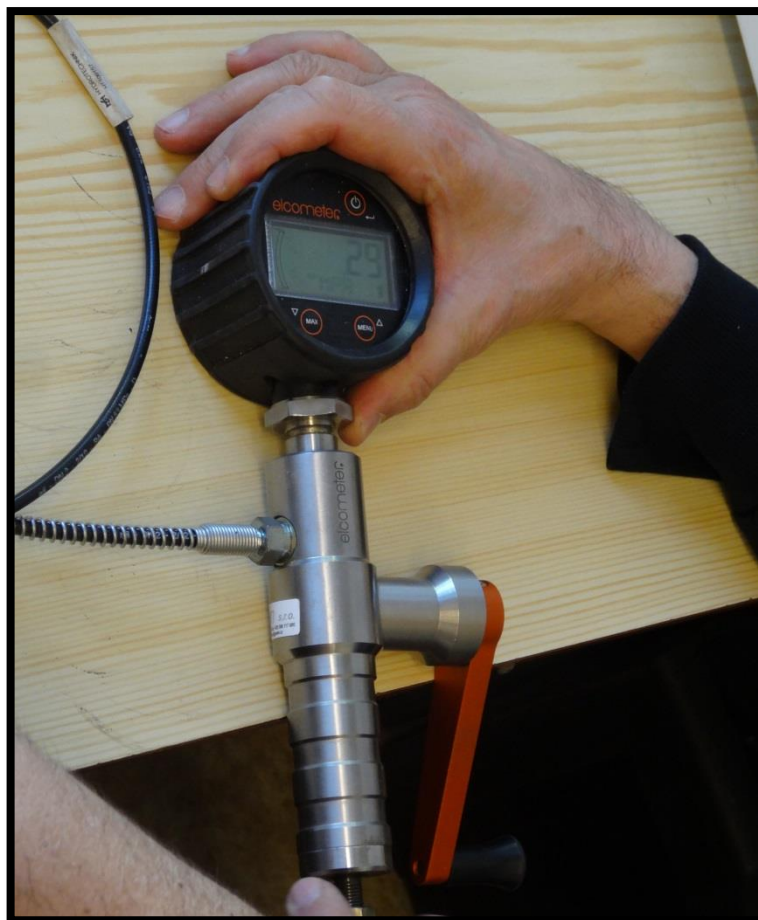
Obr. 48 - Odečtení naměřené hodnoty z odtrhoměru (Zdroj: Vlastní zpracování)
