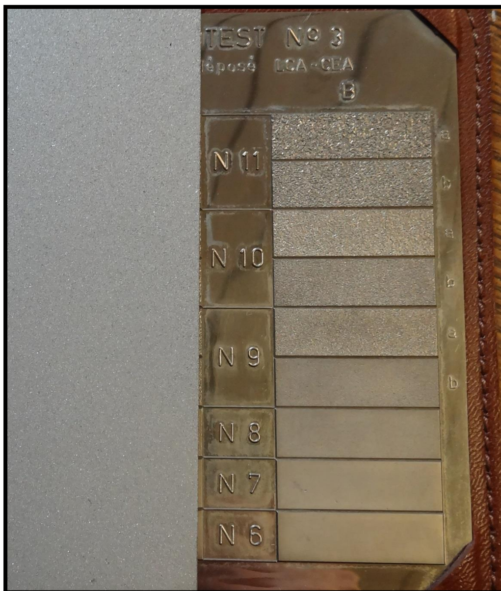
Obr. 23 - Porovnání hotového vzorku s Rugotestem (Zdroj: Vlastní zpracování)
