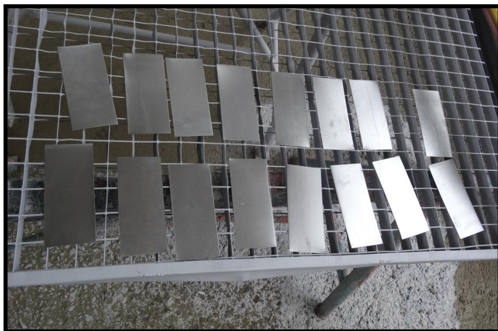
Obr. 25 - Vzorky připravené k otryskání (Zdroj: Vlastní zpracování)
