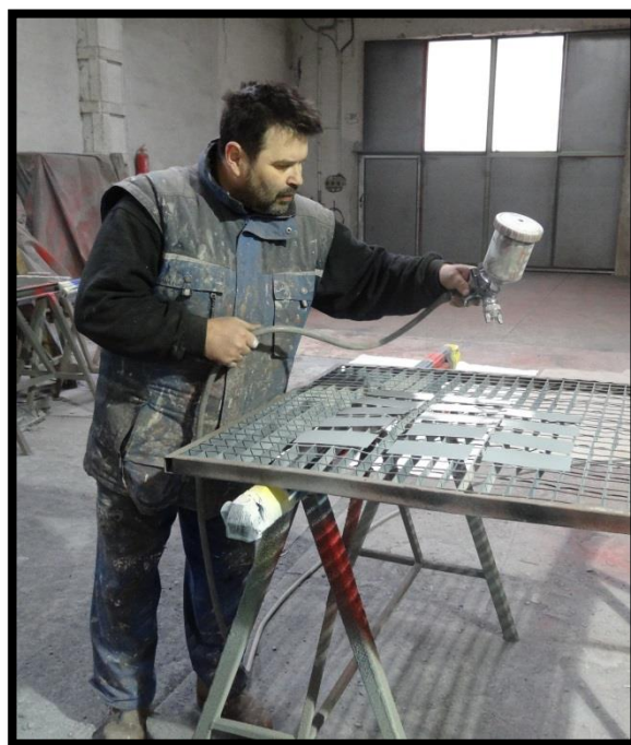
Obr. 27 - Aplikace nátěrového systému Hempadur fast dry (Zdroj: Vlastní zpracování)
