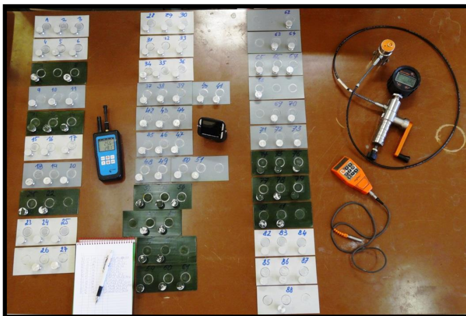
Obr. 57 - Veškeré použité pomůcky a vzorky pro odtrhovou zkoušku (Zdroj: Vlastní zpracování)
