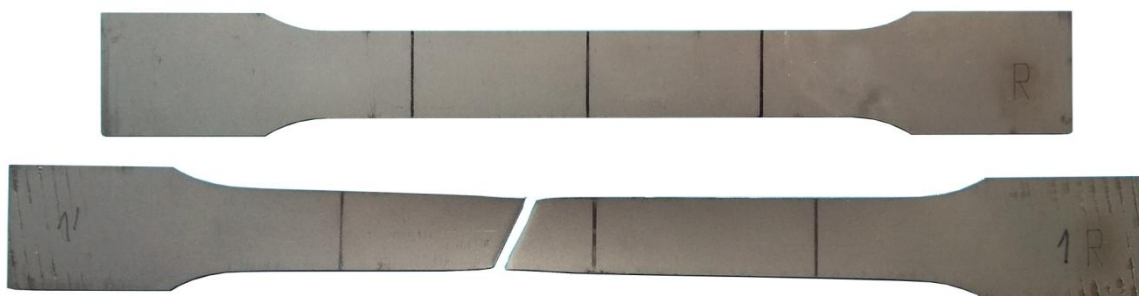
Obr. 61 Zkušební těleso před a po tahové zkoušce
