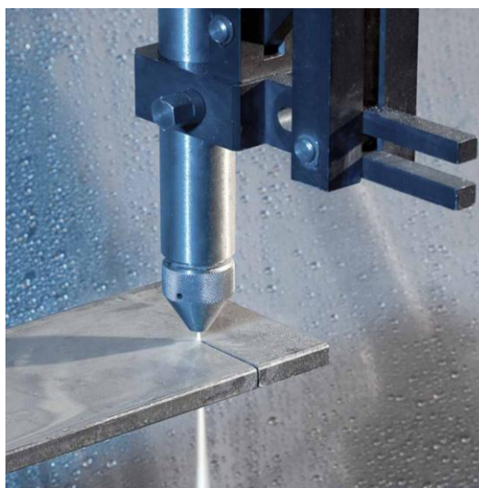
Obr. 6 Řezání vodním paprskem [17]
