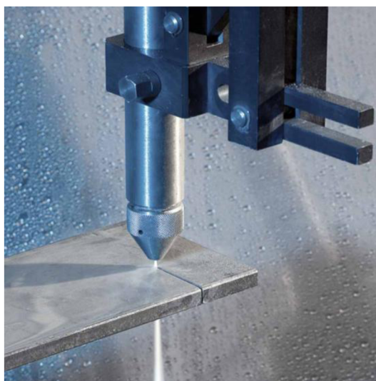
Obr. 6 Řezání vodním paprskem [17]
