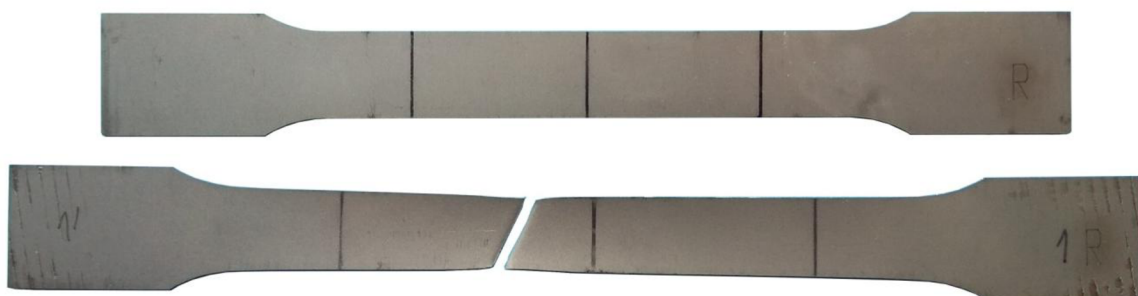
Obr. 61 Zkušební těleso před a po tahové zkoušce
