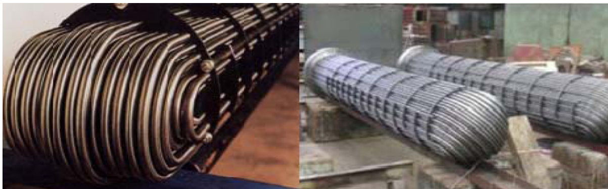
Obr. 2.6 Svazek trubek U-trubkového výměníku [12].
