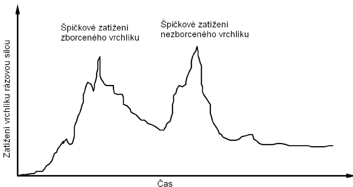
Graf 3.3 Typický průběh zatížení pro vrchlíky náchylné ke zborcení [10]
