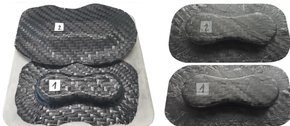
Obr. 30 Laminace a finální díly vyrobené dvoudílnou formou.
