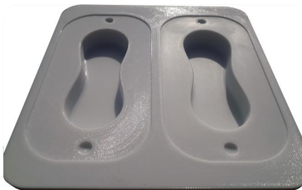
Obr. 28 Postupné broušení ploch polykarbonátové formy.
