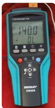
Obr. 43 Teplota předehřevu zobrazená na termometru EM589.
