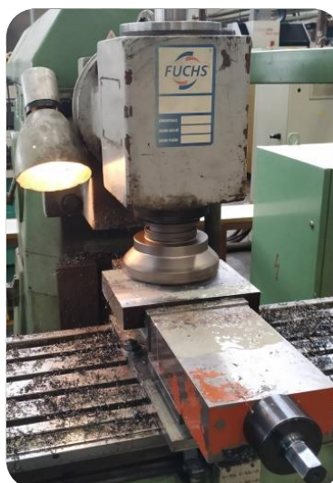
Obr. 34 Frézování kontaktních ploch.
