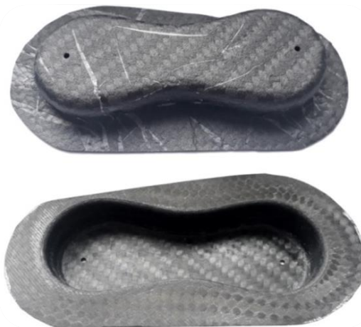
Obr. 27 Finální díly vyrobené pomocí jednodílné formy.
