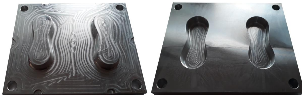
Obr. 42 Dvoudílná hliníková forma.
