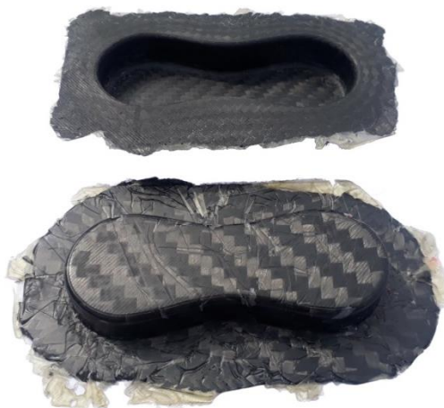
Obr. 32 Díly těsně po vyjmutí z dvoudílné formy.
