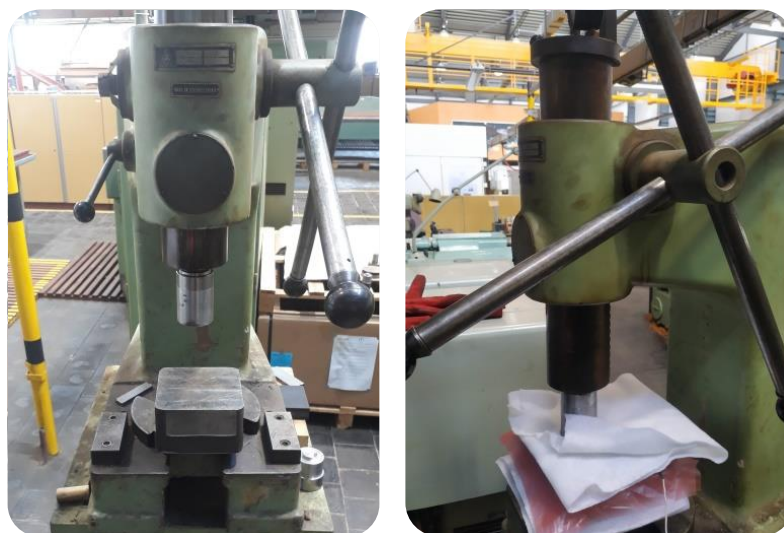
Obr. 37 Lisování rovinných dílů na lisu CTC 5.
