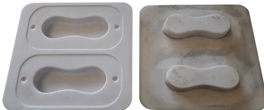
Obr. 29 Dvoudílná polykarbonátová forma.
