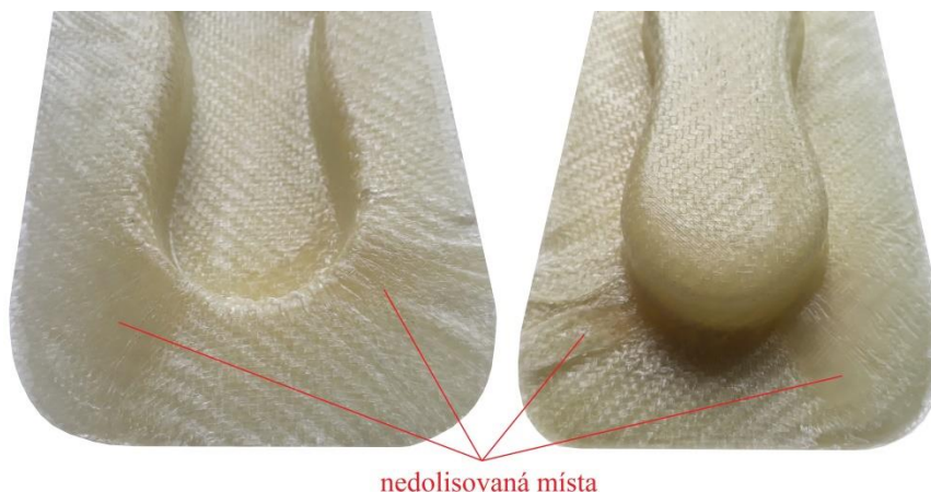
Obr. 41 Vady vytvrzených prototypových dílů.
