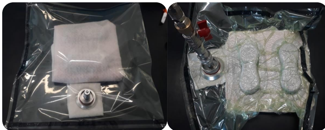
Obr. 25 Um st n  do vakuov ho a od erp n  vzduchu.
