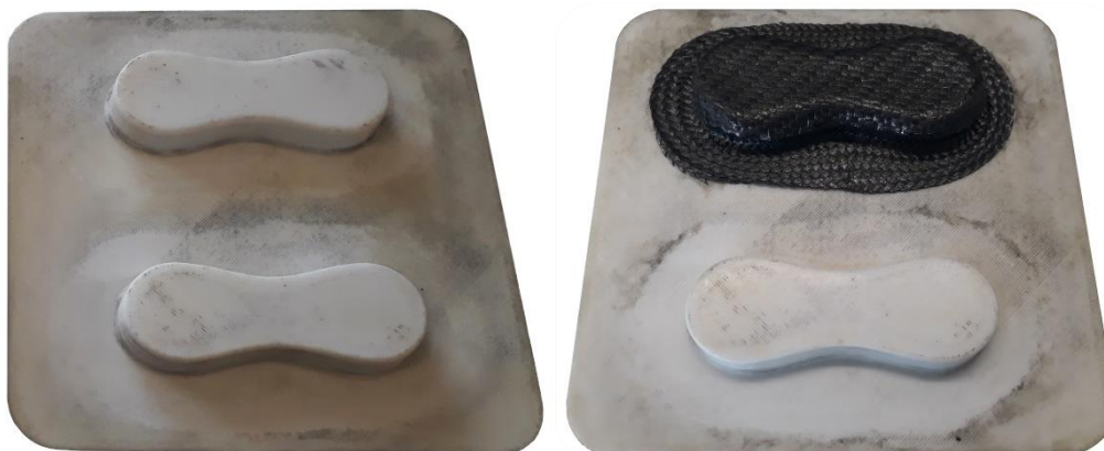
Obr. 22 Laminace na polykarbonátovou formu.
