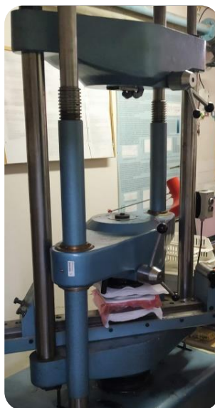
Obr. 40 Hydraulický lisovací stroj ZD40/400kN.
