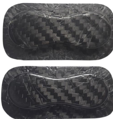
Obr. 33 Srovnání nalakovaného a nenalakovaného dílu.
