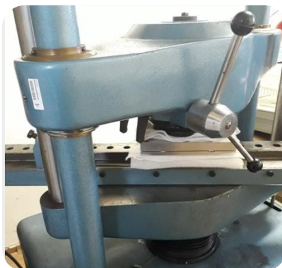
Obr. 44 Lisování na lisu ZD40/400kN s dvoudílnou hliníkovou formou.
