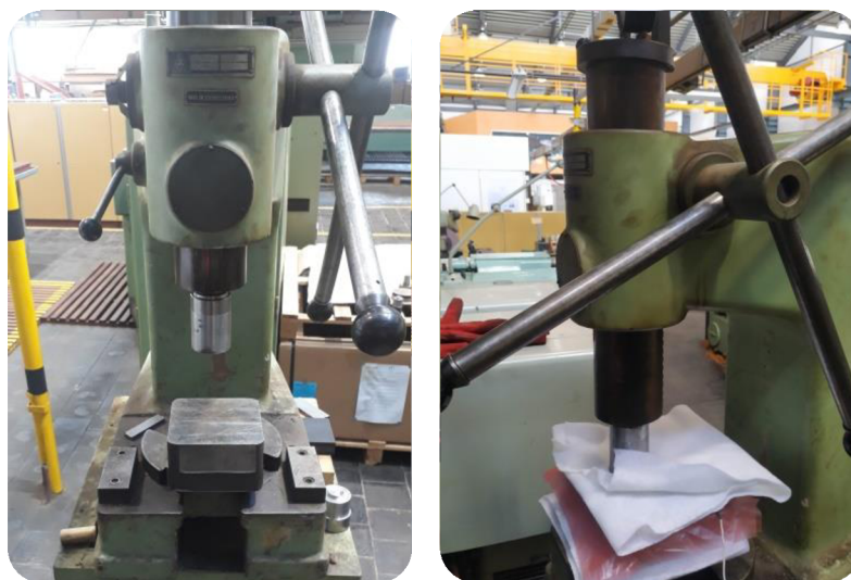
Obr. 37 Lisování rovinných dílů na lisu CTC 5.
