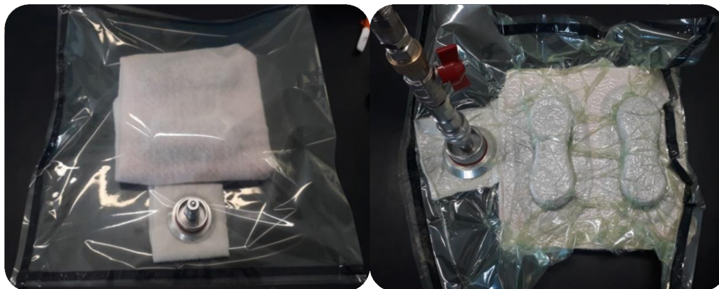
Obr. 25 Umístění do vakuového a odčerpání vzduchu.
