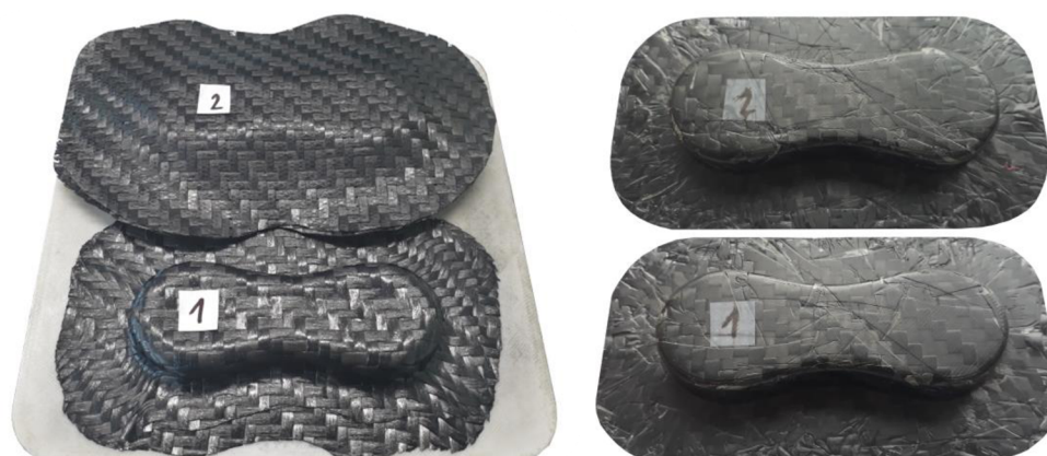
Obr. 30 Laminace a finální díly vyrobené dvoudílnou formou.
