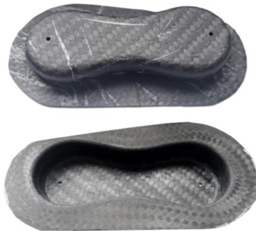
Obr. 27 Finální díly vyrobené pomocí jednodílné formy.
