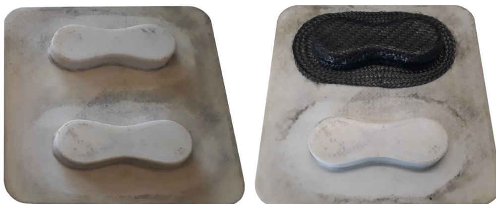
Obr. 22 Laminace na polykarbonátovou formu.
