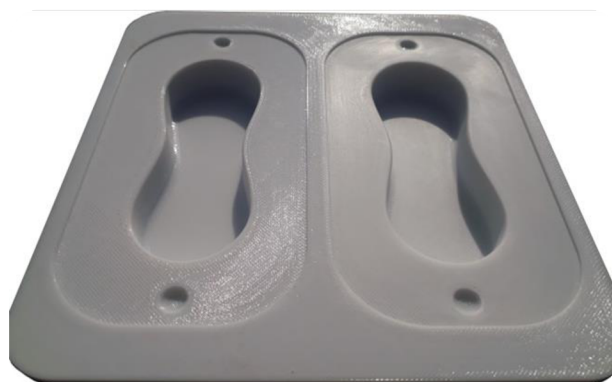
Obr. 28 Postupné broušení ploch polykarbonátové formy.
