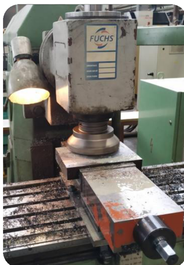
Obr. 34 Frézování kontaktních ploch.
