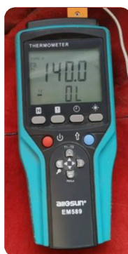
Obr. 43 Teplota předehřevu zobrazená na termometru EM589.
