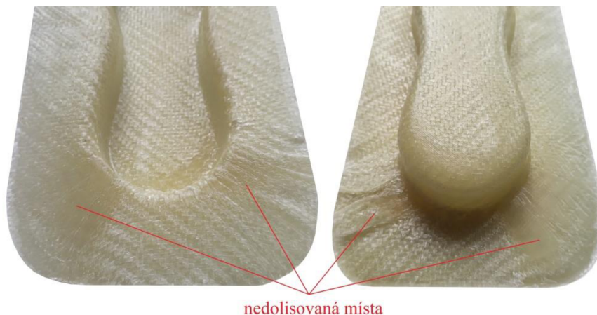
Obr. 41 Vady vytvrzených prototypových dílů.
