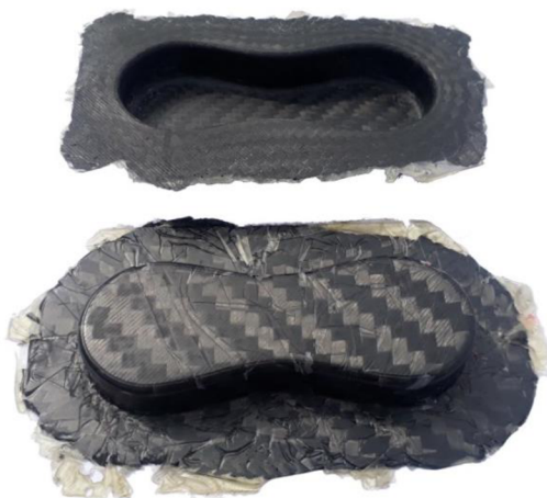
Obr. 32 Díly těsně po vyjmutí z dvoudílné formy.
