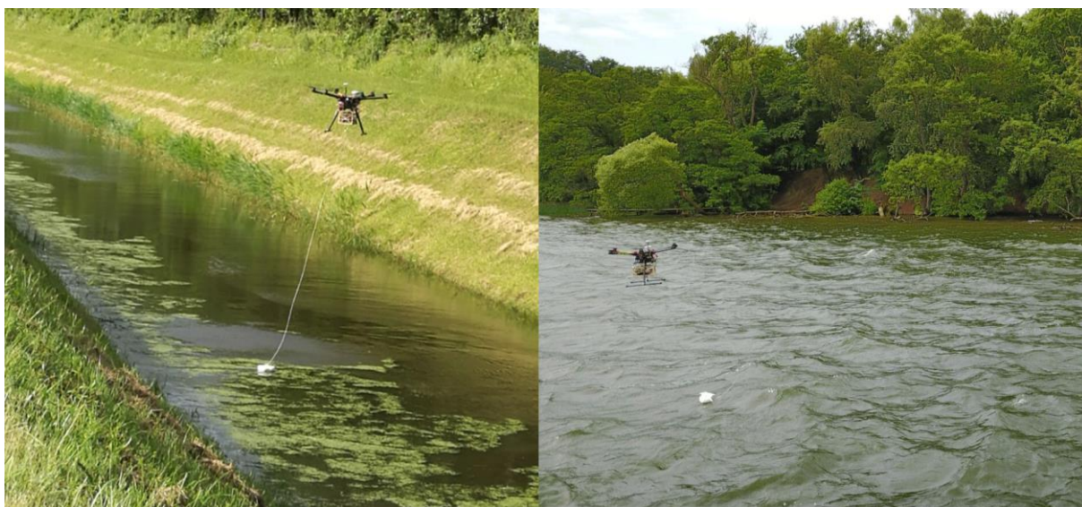
Obrázek 19 Hexakoptéra DJI Spreading Wings S900 vybavený Deeper Smart Sensor PRO+ vyrobený společností Deeper. ( https://hess.copernicus.org/articles/22/4165/2018/hess-22-4165-2018-f01-web.png )
