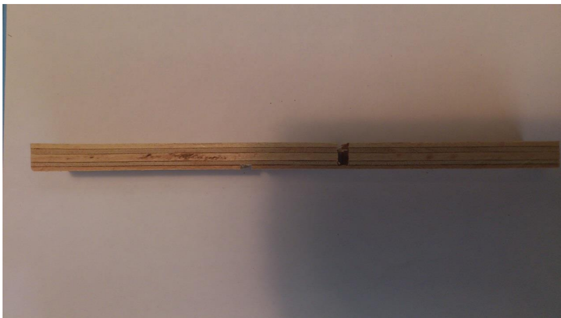
Obrázek 15: Použitá testovací tělíska pro zkoušku smykové pevnosti krajní lepené spáry.
