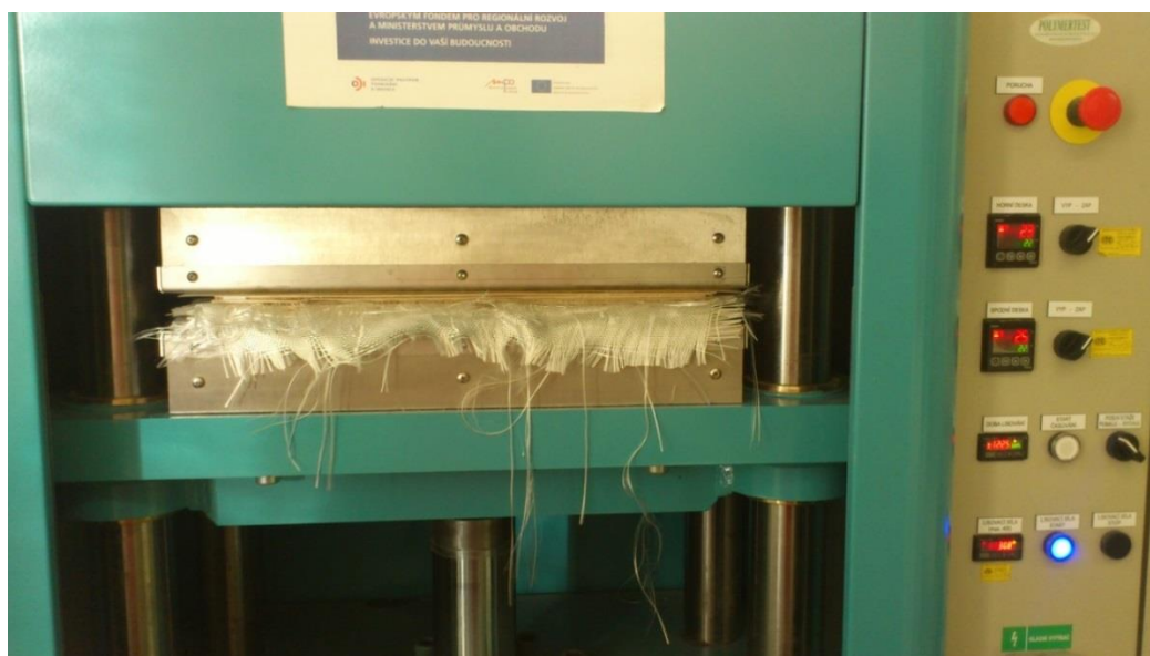
Obrázek 12: Lisování překližek na školním lisu v budově T
