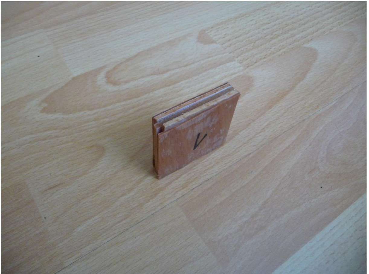
Obrázek 16: Testovací tělísko použité na měření hustoty a následně na zkoušku bobtnání po 24 hod. uložení ve vodě. Na tělísku je mimo jiné velmi dobře vidět rozdílné velikosti bobtnání v různých anatomických směrech
