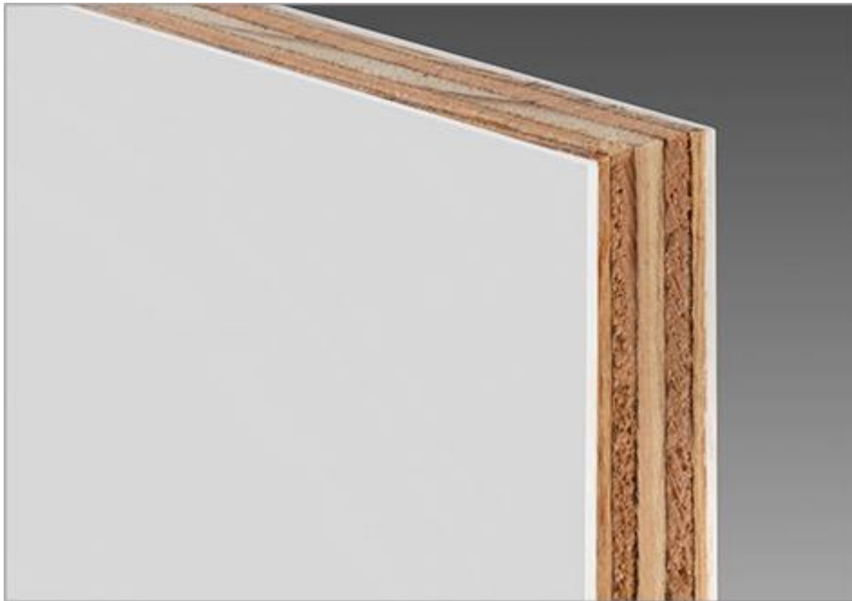
Obrázek 10: FRP- pětivrstvá překližka vyztužena skelnými vlákny slepenými polyuretanovou pryskyřicí ( http://www.morgancorp.com )
