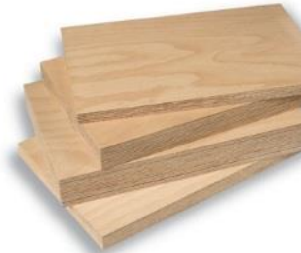
Obrázek 6: Dyas multiplex – Mnohvrstvé překližované desky složené z bukových dýh (Dyas.cz)
